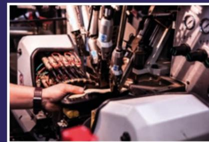
Montage de l'arrière et des flancs de la chaussure
